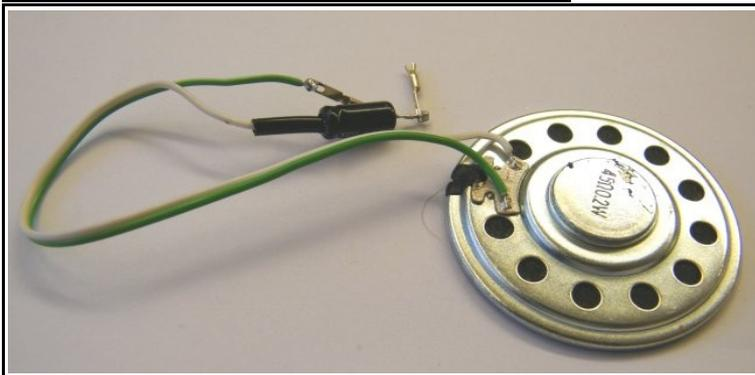
Der Lautsprecher ist über einen Elko 47  $\mu$ F mit den Steckanschlüssen verbunden. Die grüne Anschlussleitung ist an Plus, die weiße Leitung mit dem Elko an einen Portausgang anzuschließen.
